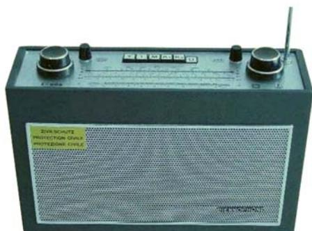
S'il y a encore des récepteurs radio E-606, ils peuvent être raccordés aux boîtes de raccordement d'antennes au moyen de leurs accessoires. La réception radio peut également être garantie à l'aide d'une antenne à long fil placée à l'extérieur (voir chap. 4, ch. 5)
