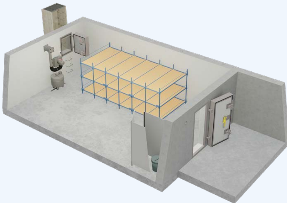
Fig. 9 L'équipement obligatoire comprend des lits et des toilettes sèches. Ils doivent être amenés dans l'abri et installés conformément aux instructions et aux plans.
