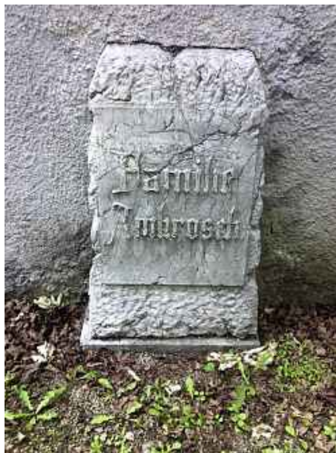
2 Grabstein am Friedhof in Ljubljana (Slowenien) aus dichtem Kalkstein. Beispiel für Oberflächenabtrag in Form von Mikrokarst. Foto © Institut für Konservierung und Restaurierung, Universität für angewandte Kunst Wien.
