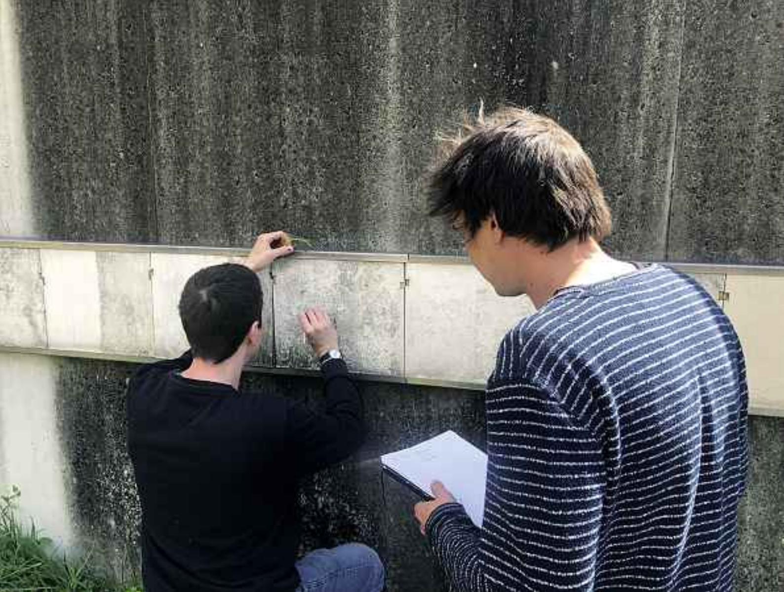
3 Monitoring von Schlämmplatten, welche über mehrere Jahre der freien Bewitterung ausgesetzt werden. Foto © Institut für Konservierung und Restaurierung, Universität für angewandte Kunst Wien.
